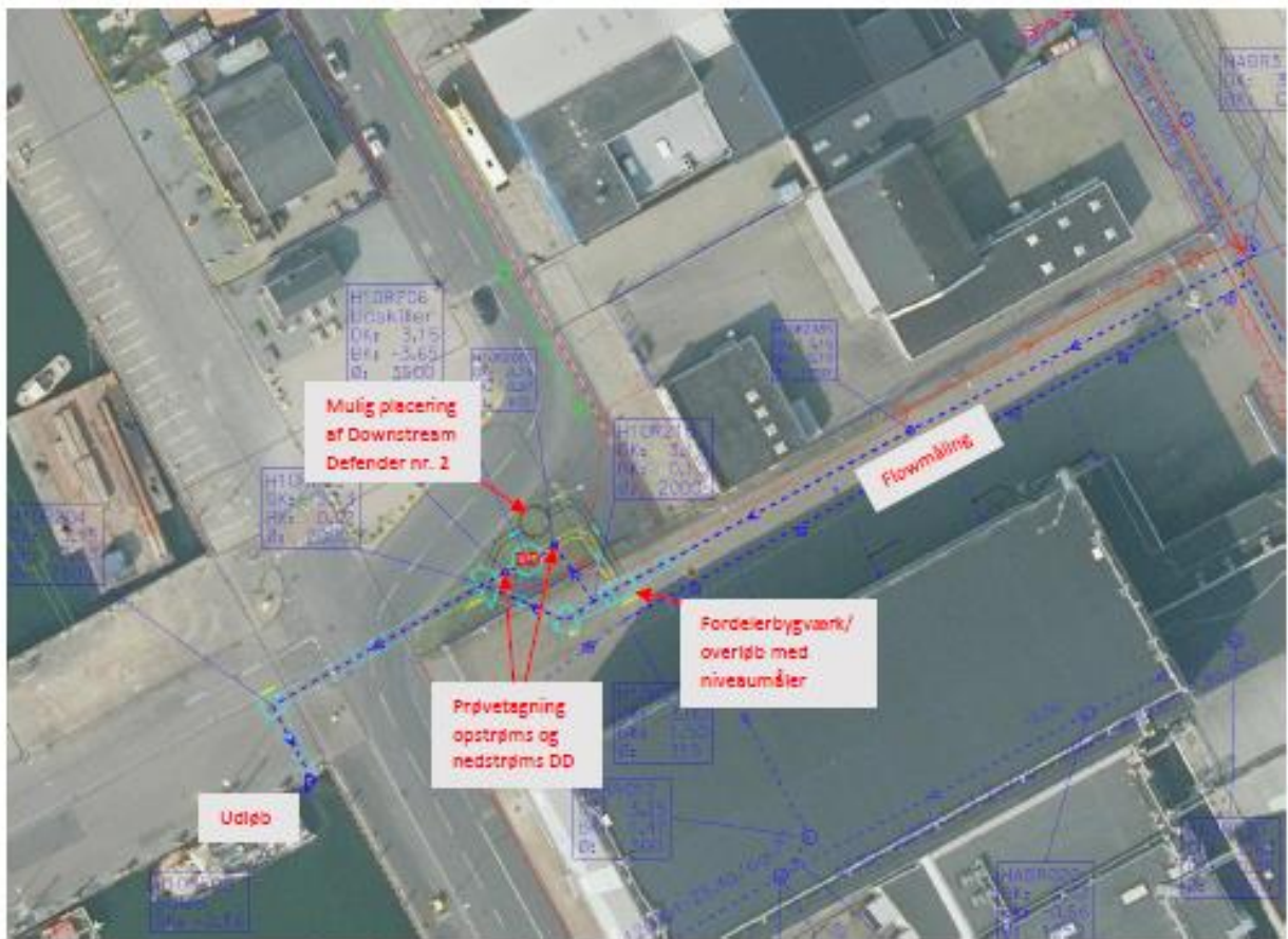
Figur 1 Placering af renseløsning og målepunkter.
