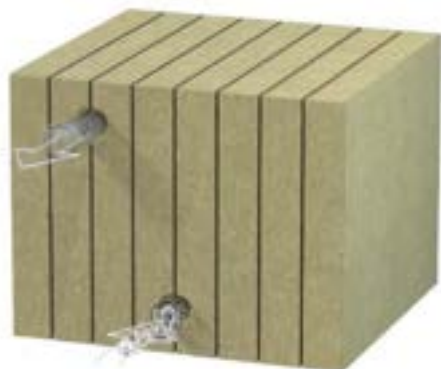
Figur 4: Indløbskanal i bunden af et Rockflow magasin, med udluftningskanalen vist i toppen. Normalt vil man modsat illustrationen anbefale, at vandet tilføres i den øverste fordelerkanal.
