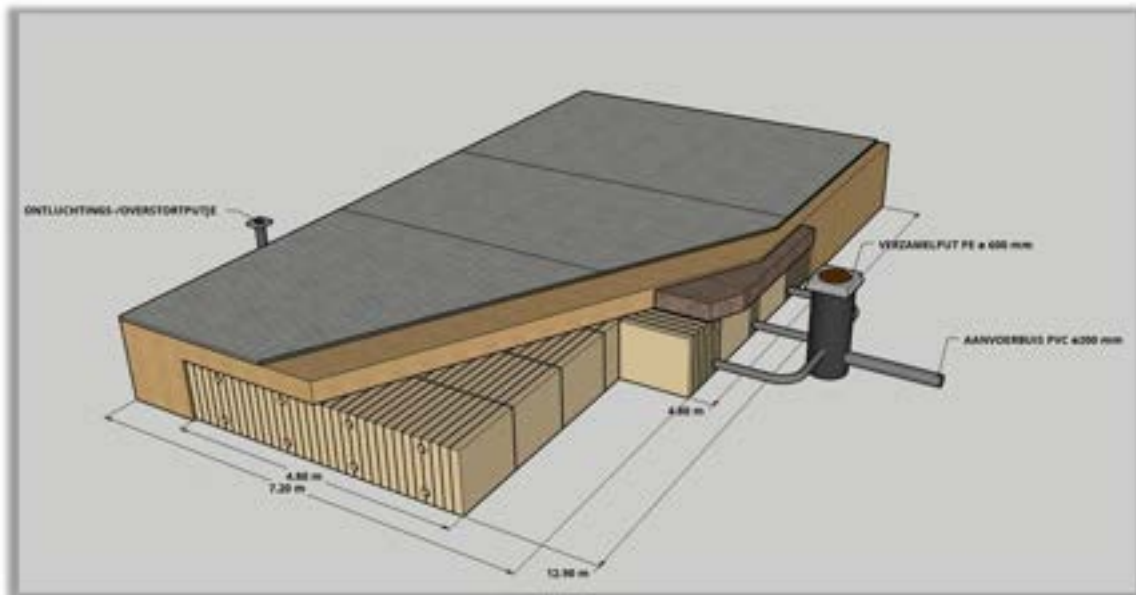
Figur 17: Principskitse for faskine/magasin etableret af Rockflow. Tilløb til fordelingskanalerne i bunden af anlægget sker via en vejbrønd med indbygget sandfang. Udluftning sker gennem kanalerne i toppen af anlægget.
