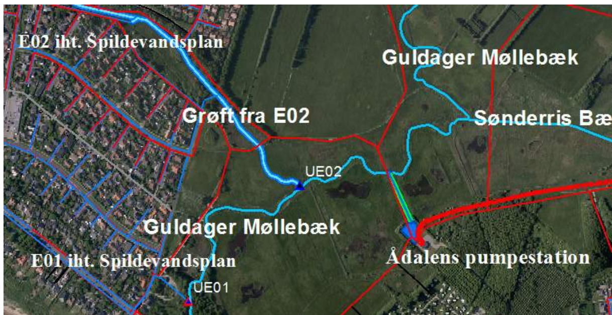
Figur 4-4. Guldager Møllebæk nedstrøms Sønderriis Bæk. Den røde trekant er et nedlagt overløbsbygværk - der udledes nu kun regnvand ved UE01.
