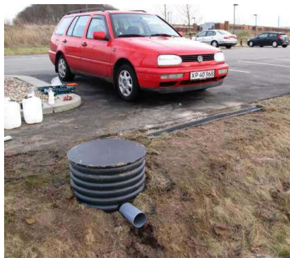
Figur 13. Billeder af systemet til opsamling af indløbsprøver: linjedræn og prøveopsamlingsbrønd. Bemærk overløbsrøret som aktiveres når de første 20 liter vand er opsamlet i brønden.
