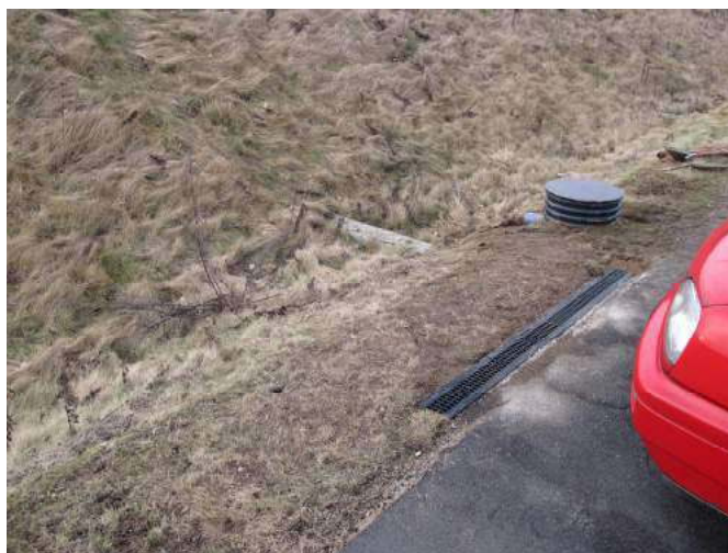
Figur 13. Billeder af systemet til opsamling af indløbsprøver: linjedræn og prøveopsamlingsbrønd. Bemærk overløbsrøret som aktiveres når de første 20 liter vand er opsamlet i brønden.
