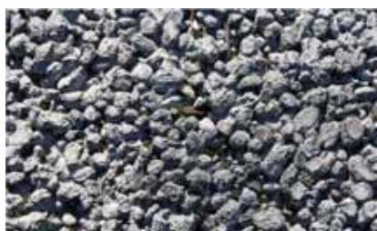
Drænasfalt Foto: Orbicon
