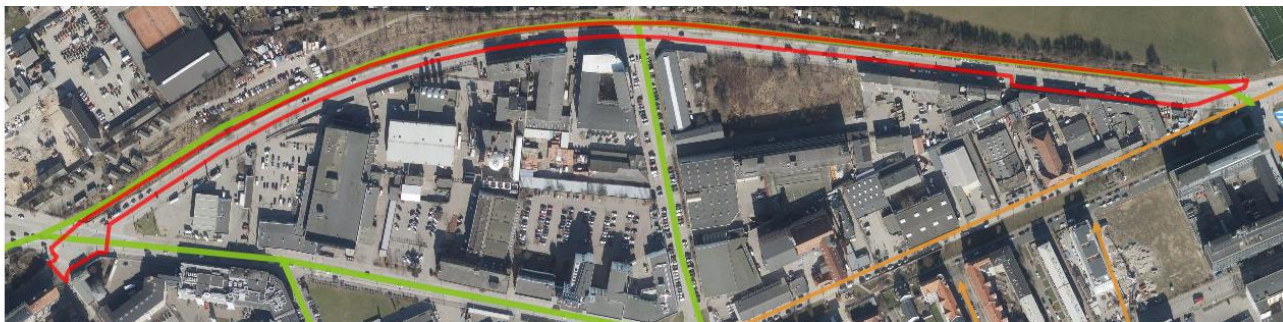
Figur 2-1: Den røde indramning viser strækningen på Uplandsgade, hvorfra vejvand fra den ene halvdel af vejen skal ledes til regnvandssystemet og til grøften med filterjord.
