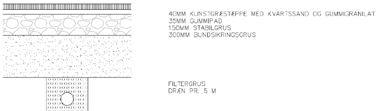
Figur 4.1 Opbygning af kunstgræsbane ved Nandrupsvej Idrætsanlæg /20/.
